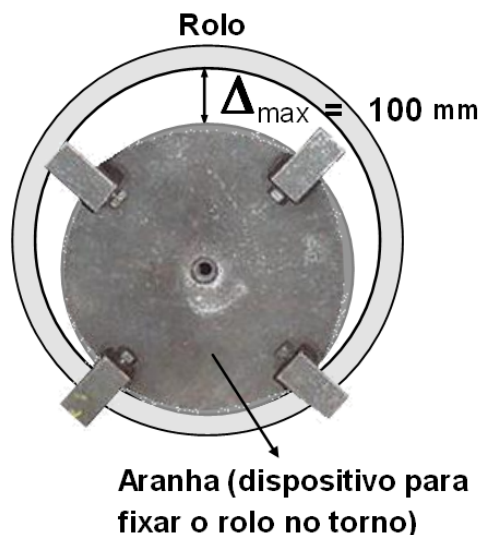
Figura 37 – Aranha, dispositivo utilizado no processo de desbaste.
