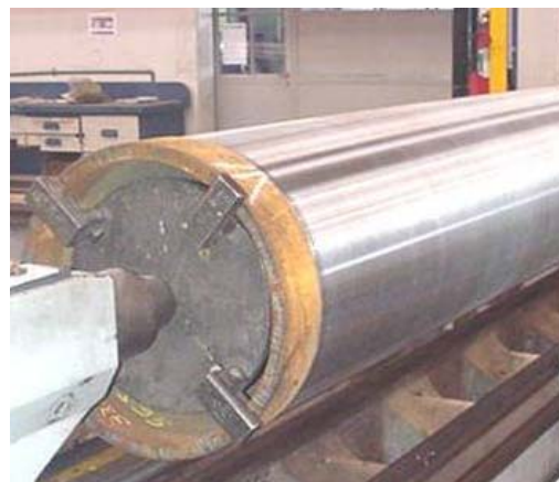
Figura 37 – Aranha, dispositivo utilizado no processo de desbaste.
